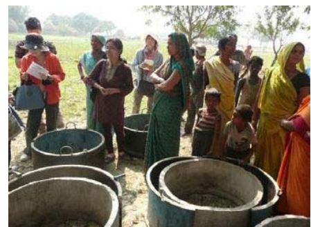
トイレの下水管リング製作現場
